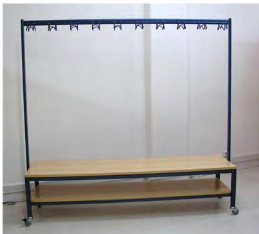
Estrutura em tubo de aço oval 40x20x2 mm macio com a espessura de 1,5mm, na parte superior e tubo de aço quadrado 30x30x1,5 mm, à parte da prateleira e assento. Soldados electricamente, superfície do tubo com tratamento anti-desengorduramento e tratamento anti-corrosão; pintura a resina epoxida em pó termoendurecível de meio brilho.
