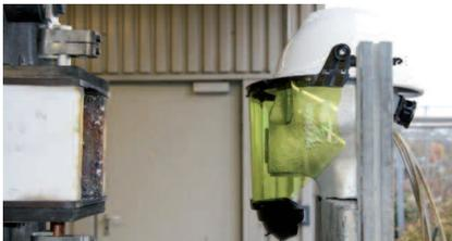
Conjunto contra arco eléctrico de MSA antes del "ensayo de arco en caja" 7 kA
