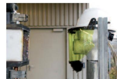
Conjunto contra arco eléctrico de MSA antes del "ensayo de arco en caja" 7 kA
