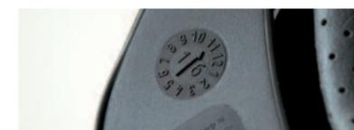
NOTA: el "código de fecha" en la visera del casco de MSA es la fecha de fabricación (inyección de la copa), no la fecha de inicio real de uso, dado que el periodo entre la fecha de fabricación y la fecha de distribución al usuario puede variar.
