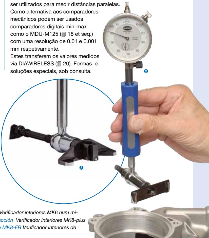
① Alexómetro MK6 en un Micrómetro Verificador interiores MK6 num micrómetro ② Alexómetro MK8-plus en acción Verificador interiores MK8-plus em ação ③ Alexómetro con base plana MK8-FB Verificador interiores de fundo plano MK8-FB
