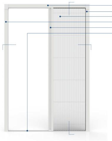
guida superiore autoportante riscontro terminale rete anti-insetto battuta barra maniglia guida a terra 'extra-flat' (nera)
